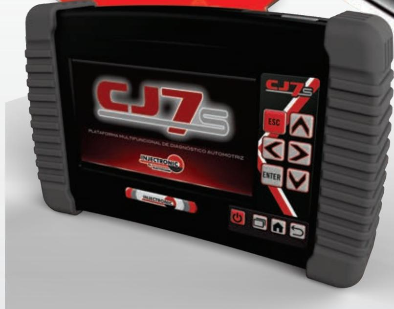
Los módulos VCM (Vehicle Communication Module) tienen la capacidad de funcionar como módulos de protocolos OBD-2, reprogramadores J2534, osciloscopios y unidades de almacenamiento, entre otros.
